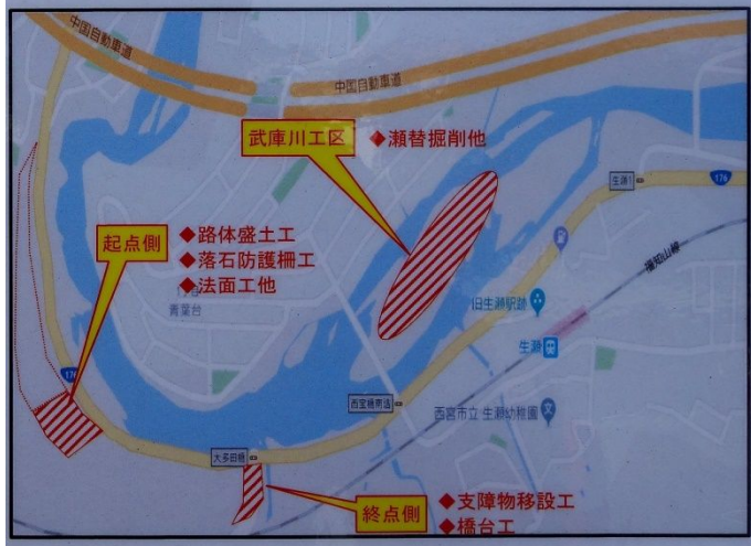
西宝橋上下で大規模な瀬変えと仮設道路工事
